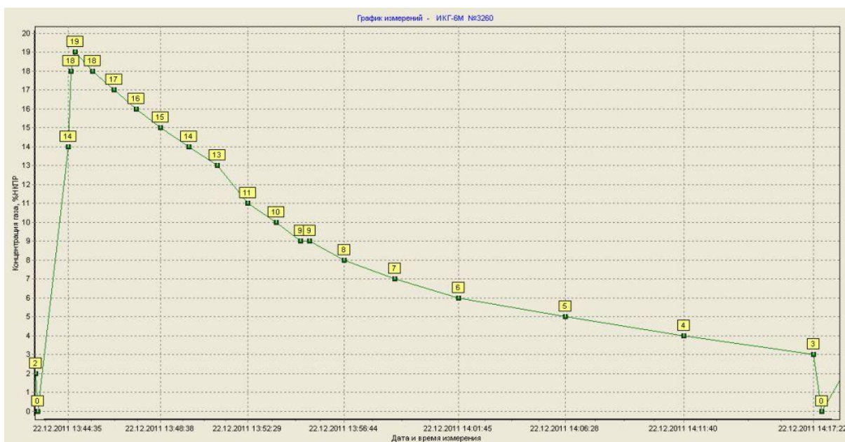
Рис. 1. Пример занижения показаний газоанализатора при подаче газозвушной смеси, содержащей метан (20 % НКПР) и сероводород (1 ПДК).
