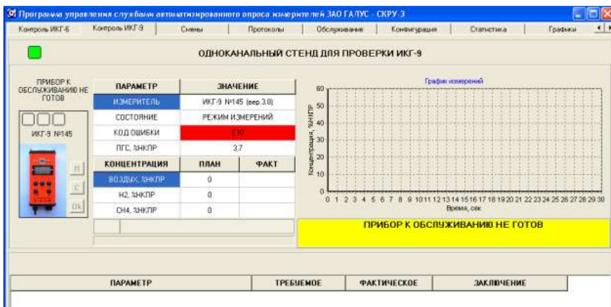
Рис.3. Заключение о неготовности прибора к обслуживанию – код неисправности E10.
